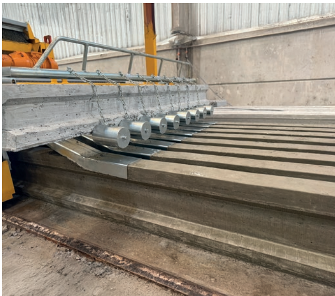
Poutrelles en I fabriquées avec la machine à coffrage glissant de Nordimpianti
