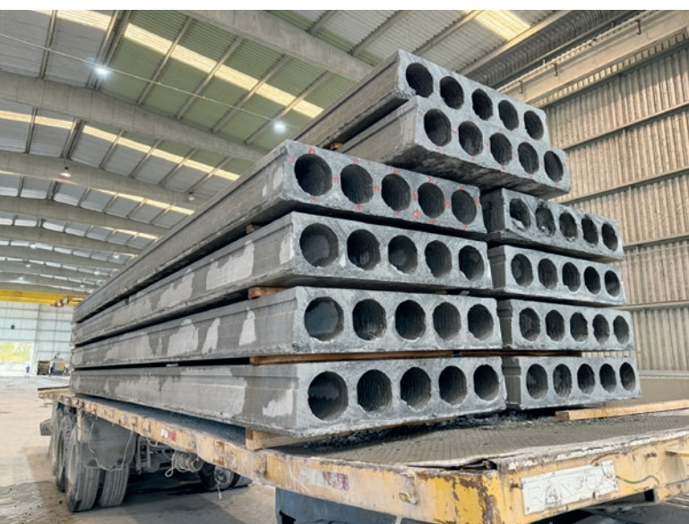
Dalles en béton précontraintes à 5 alvéoles, coulées avec l'EVO2 de Nordimpianti
