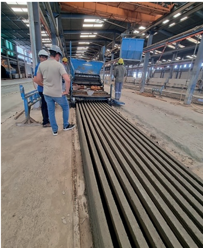
Fabrication de poutrelles en I avec la machine à coffrage glissant de Nordimpianti
