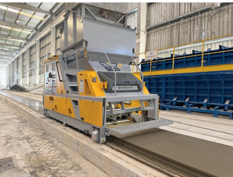
Finition de surface de haute qualité obtenue avec l'extrudeuse EVO2 de Nordimpianti
